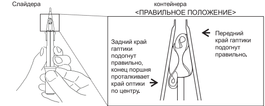
Рис. 8. Шаг 5 — проверка правильности положения
