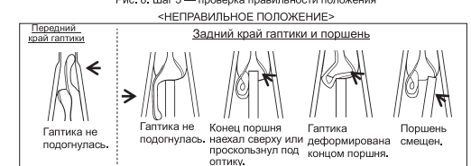
Рис. 9. Шаг 5 — при неправильном положении дальнейшее перемещение запрещено
