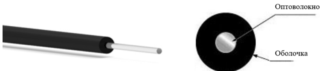
Рис. 3 – Структура оптоволокну SH3001.
