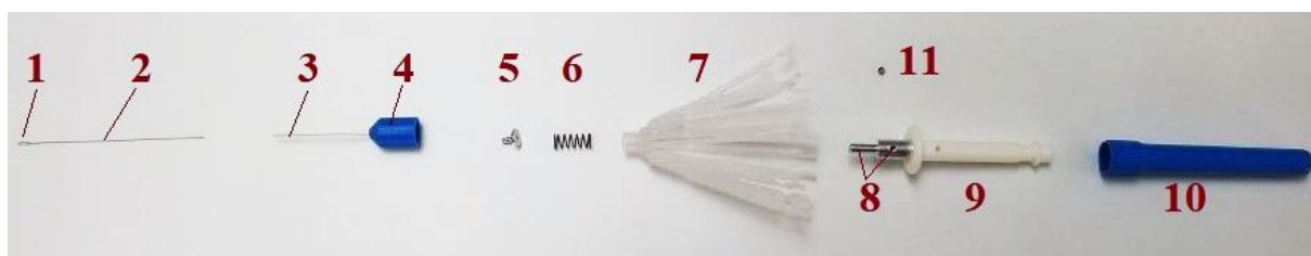
Рисунок 2 – Компоненты МИ на примере Пинцета Tweezer зажимного одноразового концевых захватывающего, размер: 25G (0,5 мм): 1 – наконечник, 2 – шток, 3 – наружная трубка, 4 – заглушка, 5 – винт, 6 – пружина, 7 – лепестковая система (клавиши активации), 8 – центральная ось, 9 – ограничитель хода, 10 – рукоятка, 11 – винт.
